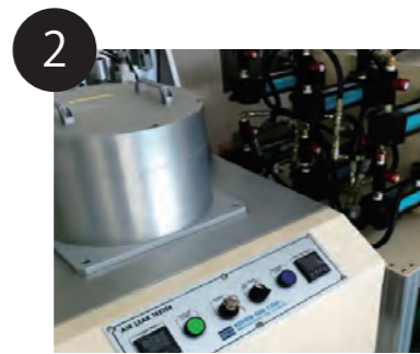
2 気密性テスト (Air Leak Test)
